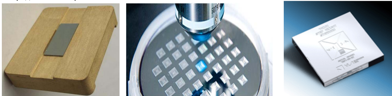
Рис.2. Комплекс разработанных мер для передачи единицы длины в области измерений шероховатости в диапазоне от 1 нм до 1000 нм.
