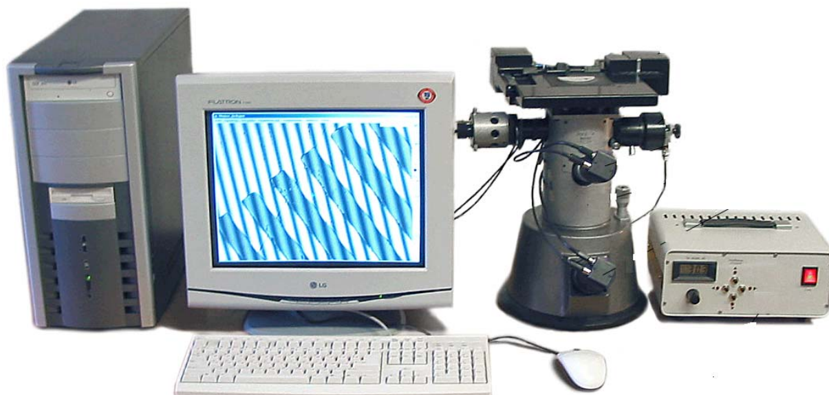
Рис.1 Макет эталонной установки на базе метода фазовых шагов
